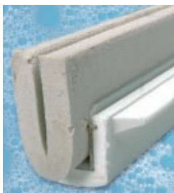
Губчатая резина изнашивается, становится чрезмерно мягкой и пористой. Продукт должен быть незамедлительно заменен.
